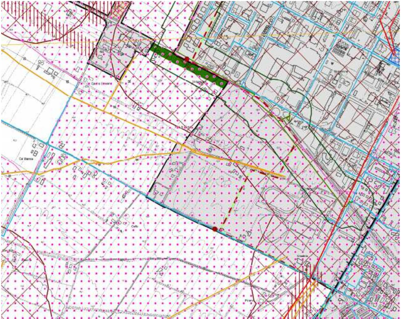
Tale elaborato definisce le principali tutele rispetto ad impianti ed infrastrutture. Sull'area in esame viene segnalata l'interferenza con la linea aerea Mt. 15 kv di competenza Enel Distribuzione S.p.A. che con il presente progetto sarà parzialmente spostata ed interrata. Inoltre si evidenzia come tutta l'area sia non idonea alla localizzazione di impianto di smaltimento e recupero dei rifiuti urbani e speciali pericolosi.
